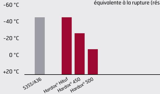
Les valeurs de résilience pour les nuances Hardox® HiTuf 450 et 500 sont des valeurs minimales garanties à -40°C, -20°C et 0°C. En comparaison avec un acier standard S355, Hardox® HiTuf a, par exemple, une résistance trois fois plus grande à la déformation permanente (dureté) et une résistance équivalente à la rupture (résilience).
